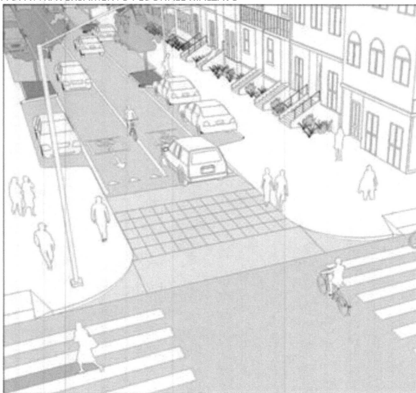
FIGURA 1: SCHEMA DI ATTRAVERSAMENTO PEDONALE RIALZATO
