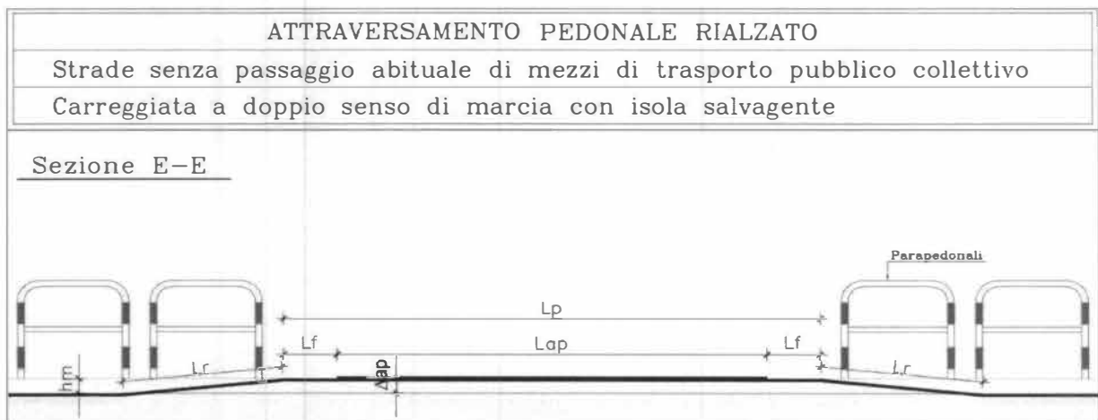
FIGURA 4D: ESEMPIO SCHEMATICO DI SEZIONE DI ATTRAVERSAMENTO PEDONALE RIALZATO PER CARREGGIATE A DUE CORSIE, PER OGNI SENSO DI MARCIA, CON ISOLA SALVAGENTE, SENZA PASSAGGIO ABITUALE DI MEZZI DI TRASPORTO PUBBLICO COLLETTIVO
